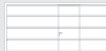
Asymmetrische Anordnung bei Torbreite BRB 3.501 - 4.250 mm – aus der Mitte links oder rechts
